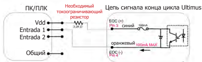
Подача сигнала конца цикла на ПК/ПЛК
