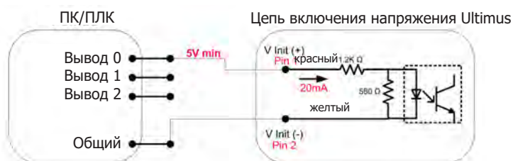
Контроль дозирования с цепью включения напряжения
