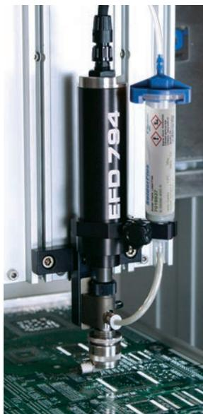
Шнековый клапан серии 794 разработан для нанесения точных, повторяемых доз паяльной пасты. Система клапана с контроллером позволяет регулировать с высокой точностью ряд параметров дозирования: время, давление воздуха на пасту в шприце, скорость вращения шнека, благодаря чему можно обеспечить строго повторяемые дозы и не повредить форму шариков сплава в пасте.
