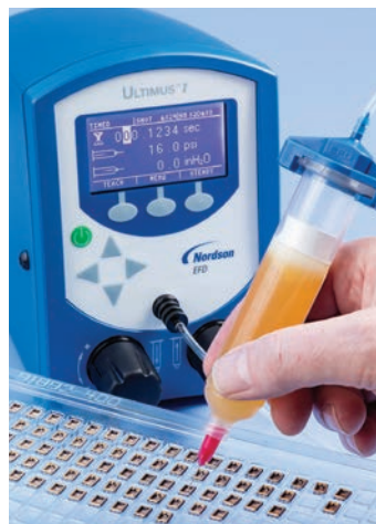
Дозирование флюса на электронные компоненты
